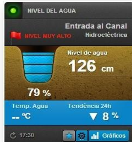
Monitorización del canal a través de la web
